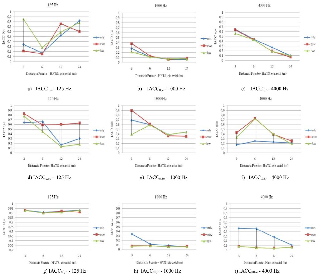
Figura 6: a), b) y c)  $IACC_{0,\infty}$ ; d), e) y f)  $IACC_{0,80}$ ; g), h) e i)  $IACC_{80,\infty}$ ; para 125, 1000 y 4000 Hz. respectivamente en posiciones de 3, 6, 12 y 24 m, igual dirección, obtenidas por mls, esw y lsw.
