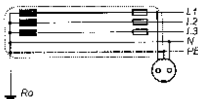
Fig. 1: Lazo de falla en sistemas TN
