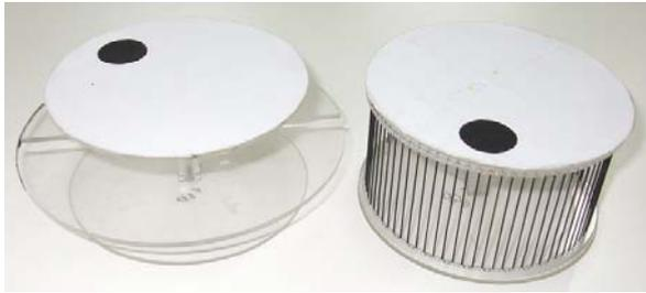
Figura 4. sistema de discos utilizados para la experiencia de choque elástico.
