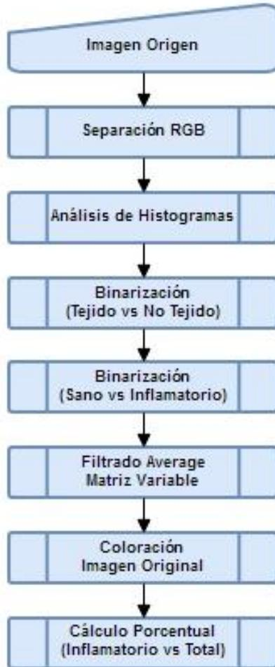
Fig. 2. Diagrama de flujo del algoritmo desarrollado
